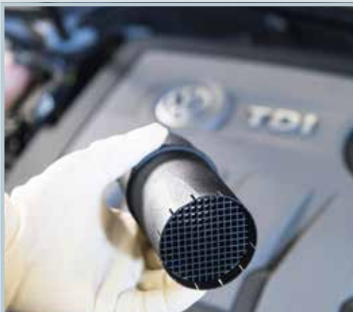
Strömungsgleichrichter für die vom Dieselskandal betroffenen Fahrzeuge
