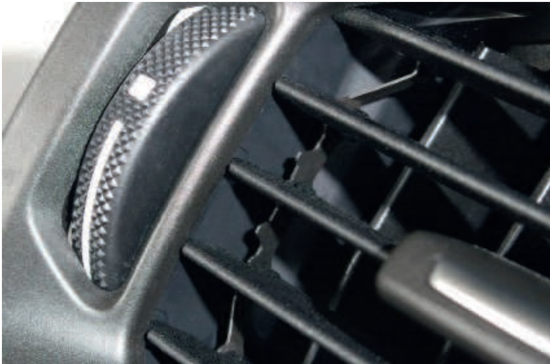
◀ Detailaufnahme der Käbme und Leisten im Luftausströmer Scania, die aus mit 10 % Glasfaser verstärkten POM gefertigt werden.
