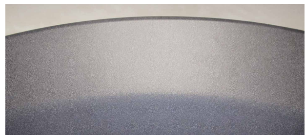
Physikalisch geschäumtes Bauteil aus talkumverstärktem PP mit AF-Complex® PE 990407 TM natur.
