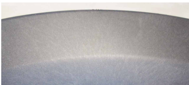
Physikalisch geschäumtes Bauteil aus talkumverstärktem PP ohne Zellnukleator.
