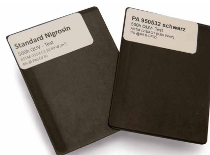
Abb. 3: PA6 GF30 Platten, eingefärbt mit PA 950532 schwarz im Vergleich zu einem Standard Nigrosin-Schwarz nach 500 h QUV-Tester [ASTM G 154 C1].
